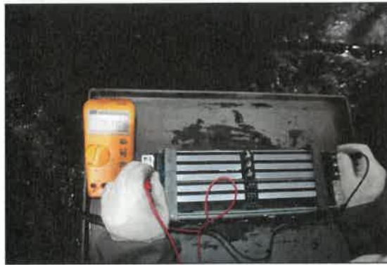
[사진 1-6] 시험 전 전압측정(3 Cell)
