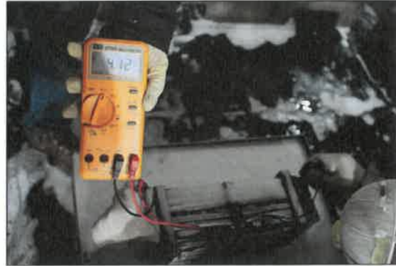
[사진 4-2] 1회 화재시험 후 전압측정
