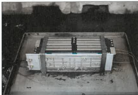
[사진 1-4] 시험용 배터리 셀(정면)
